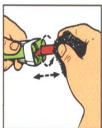
6. Rengör rör och rörkoppling med lämplig slipdyna.
